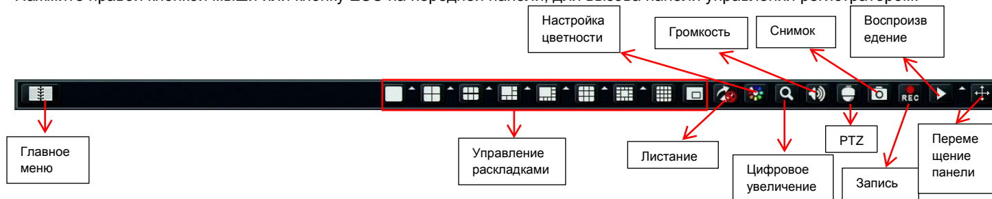
Рис.4.1 Панель управления регистратором.
